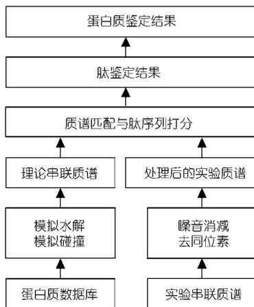
图 6 pFind 系统的主要结构图
